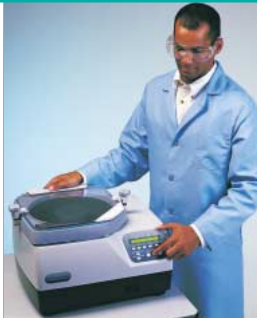
El Sistema de Evaporación por Vacío RapidVap usa vacío, calor y movimiento vorticial para acelerar la evaporación.
