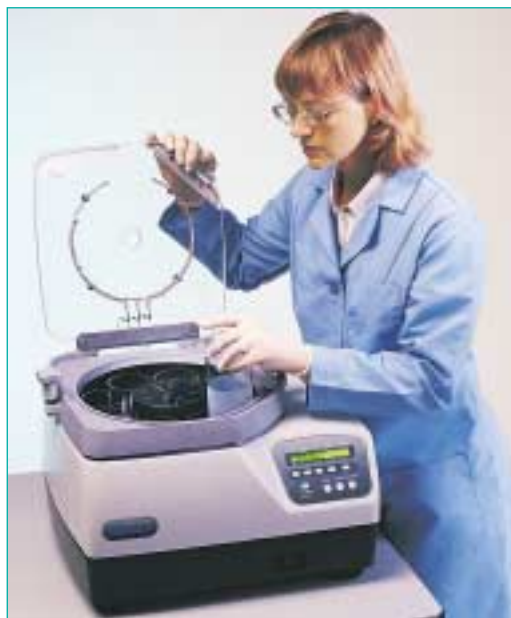
En el Sistema de Evaporación RapidVap N 2 , el nitrógeno soplado, el calor y el movimiento vorticial se combinan para reducir con rapidez varias muestras grandes.
